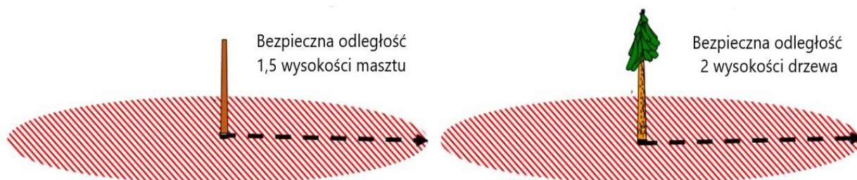
Rysunek 4: Strefa niebezpieczna podczas ścinki masztów i rzeczywistej ścinki drzew
